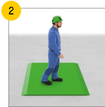
Wir sichern alle Bodenöffnungen und nicht durchbruchssicheren Bauteile.
